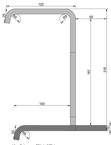
Viga C de acero F24 de 3/8" de espesor plegada, perforada y pintada. Color Pantone 412U
